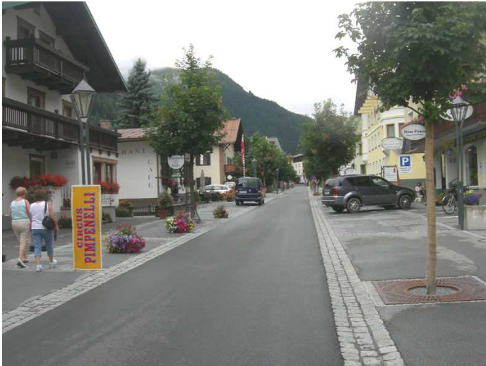
Delimitazione carreggiata con canalette
